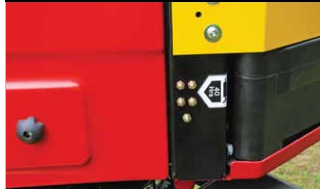
Центральный пост смазки
